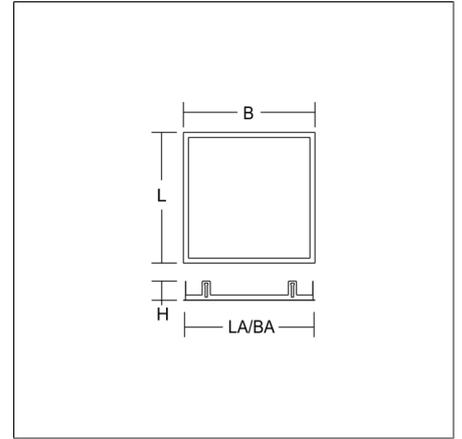
Einbaurahmen Stahlblech pulverbeschichtet. Zur Montage der Leuchte in abgehängte Decken. Einbautiefe mindestens 300 mm. Deckenstärke: 1-30 mm.
