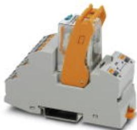
Vormontiertes Relaismodul mit Push-in-Anschluss, bestehend aus: Relaissockel, Leistungskontaktrelais, steckbarem Anzeige-/ Entstörmodul und Haltebügel. Kontaktausführung: 4 Wechsler. Eingangsspannung: 230 V AC
