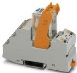
Vormontiertes Relaismodul mit Push-in-Anschluss, bestehend aus: Relaissockel, Leistungskontaktrelais, steckbarem Anzeige-/ Entstörmodul und Haltebügel. Kontaktausführung: 2 Wechsler. Eingangsspannung: 230 V AC
