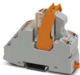
Vormontiertes Relaismodul mit Push-in-Anschluss, bestehend aus: Relaissockel, Leistungskontaktrelais, steckbarem Anzeige-/ Entstörmodul und Haltebügel. Kontaktausführung: 2 Wechsler. Eingangsspannung: 24 V AC
