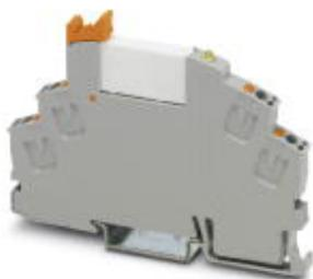
Vormontiertes Relaismodul mit Push-in-Anschluss, bestehend aus: Relaissockel mit Auswerfer und Leistungskontaktrelais. Kontaktausführung: 1 Schließer. Eingangsspannung: 24 V DC
