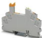
Relaissockel RIF-0..., für Miniatur-Leistungsrelais mit 1 Schließer oder baugleiche Solid-State-Relais, Push-in-Anschluss, zur Montage auf NS 35/7,5
