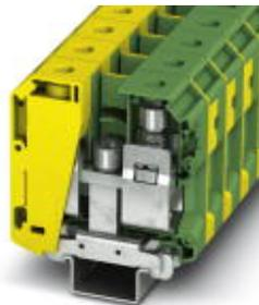
Schutzleiter-Reihenklemme, Anschlussart: Schraubanschluss, Anzahl der Anschlüsse: 2, Polzahl: 1, Querschnitt: 16 mm<sup>2</sup> - 95 mm<sup>2</sup>, AWG: 4 - 3/0, Breite: 20,3 mm, Farbe: grün-gelb, Montageart: NS 35/7,5, NS 35/15, NS 35/15-2,3, NS 32
