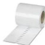
Einsteckschild, Rolle, weiß, unbeschriftet, beschriftbar mit: THERMOMARK ROLL, THERMOMARK ROLL X1, THERMOMARK ROLLMASTER 300/600, THERMOMARK X1.2, THERMOMARK S1.1, Montageart: einschieben, Kabeldurchmesserbereich: 10-25 mm, Schriftfeldgröße: 25 x 6 mm
