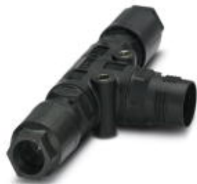
QUICKON T-Verteiler, schwarz, 4+PE-polig, 1,0 mm 2 ... 2,5 mm 2 / 690 V / 20 A, für Kabeldurchmesser 9 mm ... 16 mm, mit zwei Quickon-Muttern
