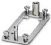
Andockrahmen für Einschübe, für Kontakteinsätze der Bauform B10, mit 4 Flachkopfschrauben M5, Einschubausgleich x/y-Achse +/- 1,5mm
