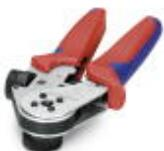
Crimpzange für gedrehte RC Crimpkontakte Durchmesser 1 mm / Durchmesser 1,5 mm / Durchmesser 2 mm für Litzenquerschnitt 0,14 mm<sup>2</sup> ... 2,5 mm<sup>2</sup>
