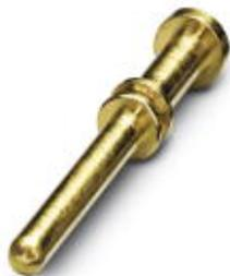
Crimpkontakt, gedreht, Einzelkontakt, Kontaktdurchmesser: 2 mm, Crimpbereich: 4 mm<sup>2</sup> ... 4 mm<sup>2</sup>
