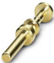
Crimpkontakt, gedreht, Einzelkontakt, Kontaktdurchmesser: 3,6 mm, Crimpbereich: 4 mm<sup>2</sup> ... 6 mm<sup>2</sup>
