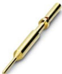
Crimpkontakt, gedreht, Kontaktdurchmesser: 0,6 mm, Crimpbereich: 0,06 mm<sup>2</sup> ... 0,25 mm<sup>2</sup>
