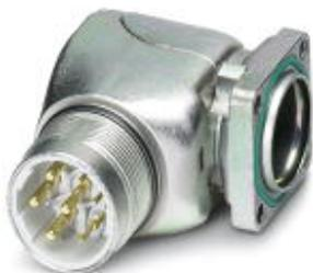
Gerätesteckverbinder, Vorderwand, gewinkelt drehbar, Schraubverriegelung, M23, Polzahl: 5+PE, Kontaktart: Stift, Crimpanschluss, O-Ring axial, 4x Ø 3,2, geschirmt: ja, Flanschmaß: 26 mm x 26 mm, Kompatibel zu Gegensteckern mit SPEEDCON- oder M23-Standard-Rändelmutter
