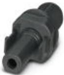
Photovoltaik-Gerätesteckverbinder, Nennspannung: 1500 V, Anschlussart: Crimp, Farbe: schwarz. nur mit Werkzeug entriegelbar
