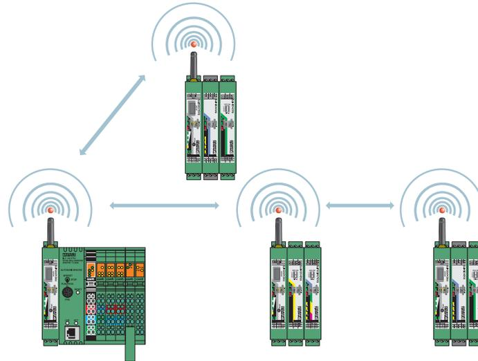
Funkmodul im PLC/Modbus-RTU-Modus
