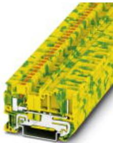
Schutzleiter-Reihenklemme, Anschlussart: Push-in- / Steckanschluss, Anzahl der Anschlüsse: 2, Querschnitt: 0,2 mm<sup>2</sup> - 6 mm<sup>2</sup>, AWG: 24 - 10, Breite: 6,2 mm, Farbe: grün-gelb, Montageart: NS 35/7,5, NS 35/15
