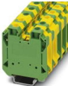
Schutzleiter-Reihenklemme, mit Schraubfuß, Anschlussart: Schraubanschluss, Anzahl der Anschlüsse: 2, Querschnitt: 1,5 mm<sup>2</sup> - 35 mm<sup>2</sup>, AWG: 16 - 2, Breite: 16 mm, Farbe: grün-gelb, Montageart: NS 35/7,5, NS 35/15
