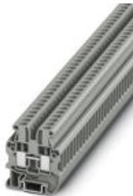
Mini-Durchgangsklemme, Nennspannung: 500 V, Nennstrom: 24 A, Anschlussart: Schraubanschluss, Anzahl der Anschlüsse: 2, Polzahl: 1, Querschnitt: 0,2 mm<sup>2</sup> - 4 mm<sup>2</sup>, AWG: 24 - 12, Breite: 5,2 mm, Farbe: grau, Montageart: NS 15
