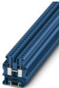
Mini-Durchgangsklemme, Nennspannung: 500 V, Nennstrom: 32 A, Anschlussart: Schraubanschluss, Anzahl der Anschlüsse: 2, Querschnitt: 0,2 mm<sup>2</sup> - 6 mm<sup>2</sup>, AWG: 24 - 10, Breite: 6,2 mm, Farbe: blau, Montageart: NS 15
