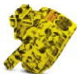
Abgriffklemme, Nennspannung: 1500 V, Nennstrom: 57 A, Anschlussart: Push-in-Anschluss, Anzahl der Anschlüsse: 2, Querschnitt: 0,5 mm<sup>2</sup> - 16 mm<sup>2</sup>, AWG: 20 - 6, Breite: 18,5 mm, Höhe: 34,7 mm, Farbe: schwarz/gelb, Montageart: auf Basiselement
