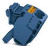
Abgriffklemme, Nennspannung: 1500 V, Nennstrom: 57 A, Anschlussart: Push-in-Anschluss, Anzahl der Anschlüsse: 2, Querschnitt: 0,5 mm<sup>2</sup> - 16 mm<sup>2</sup>, AWG: 20 - 6, Breite: 18,5 mm, Höhe: 34,7 mm, Farbe: blau, Montageart: auf Basiselement
