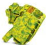
Abgriffklemme, Nennspannung: 1500 V, Nennstrom: 57 A, Anschlussart: Push-in-Anschluss, Anzahl der Anschlüsse: 2, Querschnitt: 0,5 mm<sup>2</sup> - 16 mm<sup>2</sup>, AWG: 20 - 6, Breite: 18,5 mm, Höhe: 34,7 mm, Farbe: grün/gelb, Montageart: auf Basiselement
