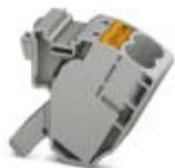
Abgriffklemme, Nennspannung: 1500 V, Nennstrom: 57 A, Anschlussart: Push-in-Anschluss, Anzahl der Anschlüsse: 2, Querschnitt: 0,5 mm<sup>2</sup> - 16 mm<sup>2</sup>, AWG: 20 - 6, Breite: 18,5 mm, Höhe: 34,7 mm, Farbe: grau, Montageart: auf Basiselement
