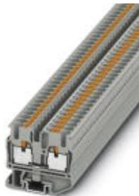
Mini-Durchgangsklemme, Nennspannung: 500 V, Nennstrom: 24 A, Anschlussart: Push-in-Anschluss, Anzahl der Anschlüsse: 2, Querschnitt: 0,14 mm<sup>2</sup> - 4 mm<sup>2</sup>, AWG: 26 - 12, Breite: 5,2 mm, Höhe: 32,1 mm, Farbe: grau, Montageart: NS 15
