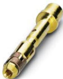
Crimpkontakt, gedreht, Einzelkontakt, Kontaktdurchmesser: 1 mm, Crimpbereich: 0,06 mm<sup>2</sup> ... 0,25 mm<sup>2</sup>
