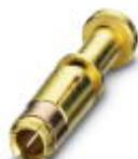
Crimpkontakt, gedreht, Einzelkontakt, Kontaktdurchmesser: 2 mm, Crimpbereich: 1 mm² ... 2,5 mm²
