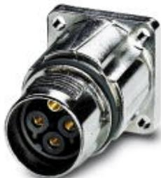
Gerätesteckverbinder, Vorderwand, gerade, SPEEDCON-Verriegelung, M17, Polzahl: 7+PE, Kontaktart: Buchse, Crimpanschluss, O-Ring axial, 4x Ø2,7, geschirmt: ja, Flanschmaß: 21,6 mm x 21,6 mm
