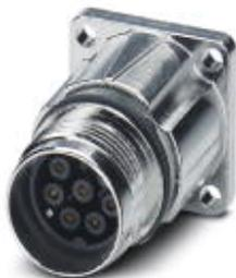
Gerätesteckverbinder, Vorderwand, gerade, SPEEDCON-Verriegelung, M17, Polzahl: 7+PE, Kontaktart: Buchse, Crimpanschluss, O-Ring axial, 4x Ø2,7, geschirmt: ja, Flanschmaß: 21,6 mm x 21,6 mm
