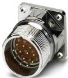
Gerätesteckverbinder, Vorderwand, gerade, Schraubverriegelung, M23, Polzahl: 17, Kontaktart: Stift, Crimpanschluss, O-Ring axial, 4x Ø 3,2, geschirmt: ja
