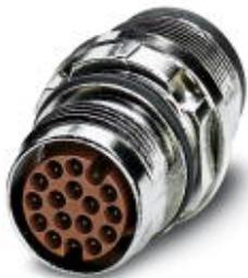
Gerätesteckverbinder, Vorderwand, gerade, SPEEDCON-Verriegelung, M17, Polzahl: 17, Kontaktart: Stift, Crimpanschluss, O-Ring axial, Zentralbefestigung, geschirmt: ja
