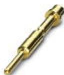
Crimpkontakt, gedreht, Einzelkontakt, Kontaktdurchmesser: 1 mm, Crimpbereich: 0,5 mm<sup>2</sup> ... 1 mm<sup>2</sup>
