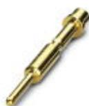
Crimpkontakt, gedreht, Einzelkontakt, Kontaktdurchmesser: 1 mm, Crimpbereich: 0,34 mm<sup>2</sup> ... 0,5 mm<sup>2</sup>
