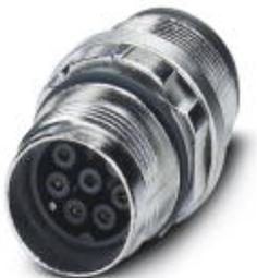
Gerätesteckverbinder, Vorderwand, gerade, SPEEDCON-Verriegelung, M17, Polzahl: 5+3+PE, Kontaktart: Buchse, Crimpanschluss, O-Ring axial, Zentralbefestigung, geschirmt: ja
