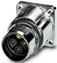
Gerätesteckverbinder, Vorderwand, gerade, SPEEDCON-Verriegelung, M17, Polzahl: 5+3+PE, Kontaktart: Buchse, Crimpanschluss, O-Ring axial, 4x Ø2,7, geschirmt: ja, Flanschmaß: 21,6 mm x 21,6 mm
