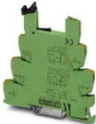
6,2 mm PLC-Grundklemme mit Push-in-Anschluss, ohne Relais- oder Solid-State-Relaisbestückung, zur Montage auf Tragschiene NS 35/7,5, 1 Wechsler, Eingangsspannung 125 V DC
