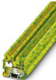
Mini-Schutzleiterklemme, Anschlussart: Push-in-Anschluss, Anzahl der Anschlüsse: 2, Querschnitt: 0,14 mm<sup>2</sup> - 1,5 mm<sup>2</sup>, AWG: 26 - 14, Breite: 3,5 mm, Farbe: grün-gelb, Montageart: NS 15
