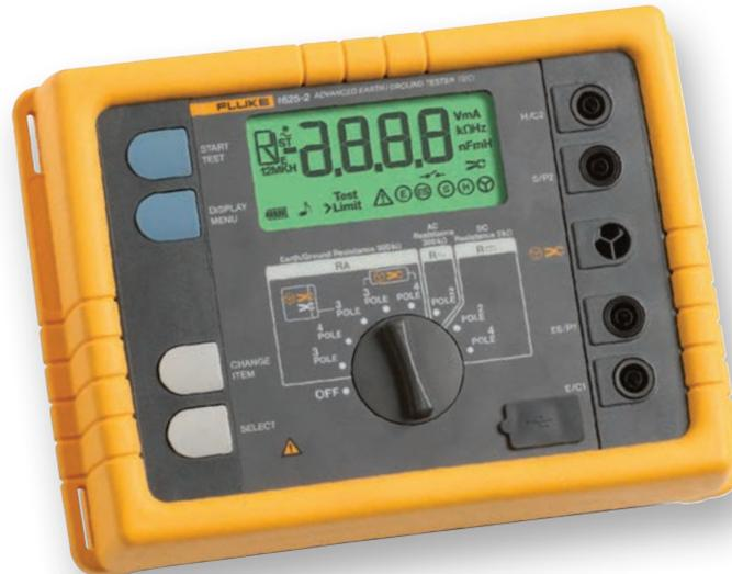
Messverfahren werden zwei Zangen um den Tiefenerder gelegt und mit dem Erdungsmessgerät verbunden. Es werden keine Erdungsspieße verwendet. Über eine der Zangen wird eine bekannte Festspannung induziert, und mit der zweiten Zange wird der Strom gemessen. Dann ermittelt das Messgerät automatisch den Widerstand des Tiefenerders.
