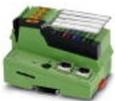
Der Inline-Controller bietet die Möglichkeit über PROFINET und Modbus/TCP zu kommunizieren. Die Programmierung erfolgt mit PC Worx Express oder PC Worx (IEC 61131-3).
