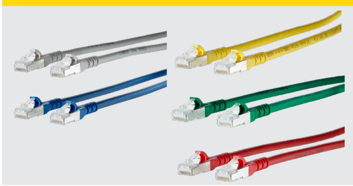
Patchkabel geschirmt Cat.6 A , 500 MHz, S/FTP LSZH
