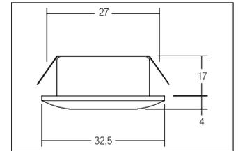
LED-Lichtpunkt, IP44, alu matt, rund. Ausgeführt in kompakter Bauform für werkzeuglose Schnellmontage zum Deckeneinbau-
