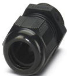
Kabelverschraubung, Material Verschraubung: PA, Kabelaußendurchmesser 11 mm ... 17 mm, Schirmung: nein, Anschlussgewinde: M25 x 1,5, Farbe: tiefschwarz RAL 9005
