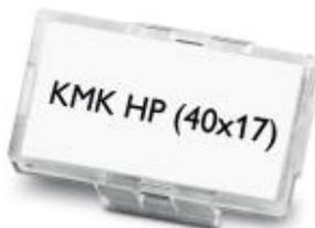
Kabelmarkerträger, transparent, unbeschriftet, Montageart: Kabelbindermontage, Kabeldurchmesser:  $\geq 9$  mm, Schriftfeldgröße: 40 x 17 mm
