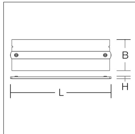
Abdeckung für DALI-Flügelstromschienen, Kunststoff weiß. Geeignet für Anfangseinspeisung bzw. Zwischeneinspeisung.
