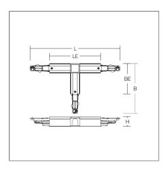
T-Kupplung, Kunststoff. Mit integrierter zusätzlicher 2-poliger-DALI-Leitung. Versorgungsleitung 16 A / 400 V. Steuerleitung DALI 2x 1 A / 50 V FELV AC.
