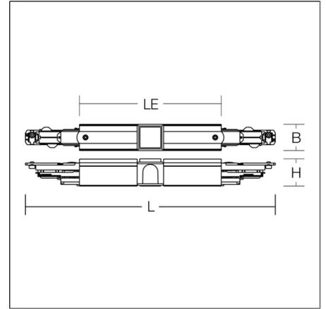
Zwischeneinspeisung, Kunststoff. Mit integrierter zusätzlicher 2-poliger-DALI-Leitung. Versorgungsleitung 16 A / 400 V. Steuerleitung DALI 2x 1 A / 50 V FELV AC.
