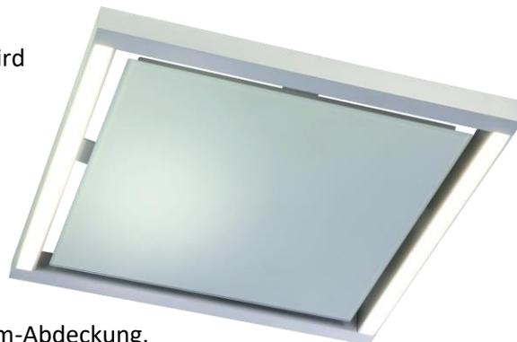
Die Befestigung des Leuchtenrahmens erfolgt über eine rückseitige Anbindung (Verbindungswinkel) an dem Heizelement. Der Leuchtenrahmen besteht aus gebürsteten und eloxierten Aluminiumstrangpressprofilen, welche über Eckverbinder miteinander verbunden werden und somit eine Einheit bilden. Zweiseitig, gegenüberliegende Profile sind als Leuchteneinheit mit hinterleuchteten diffusen Acrylglasabdeckungen ausgeführt. Die Leuchteneinheit wird elektrisch getrennt vom Heizelement geschaltet.
