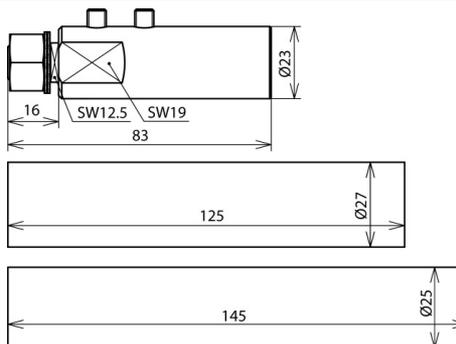
Anschlusselement zum Abschließen der HVI long Leitung, beim Erstellen des Endverschlusses der Leitung außen am Stützrohr (Kopfstück für Anschlussplatte). Inkl. zwei Schrumpfschläuche und zwei Kabelbinder.
