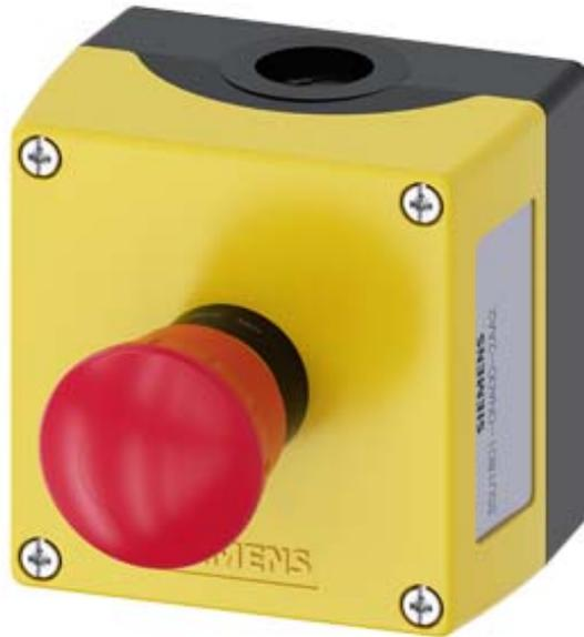
Gehäuse für Befehlsgeräte, 22 mm, rund, Gehäusematerial Kunststoff, Gehäuseoberseite gelb, 1 Befehlsstelle Kunststoff, Befehlsstelle mittig, A=NOT-HALT-Pilzdrucktaster rot, 40 mm, drehentriegelt, 1Ö, Schraubanschluss, Bodenbefestigung, oben und unten je 1xM20
