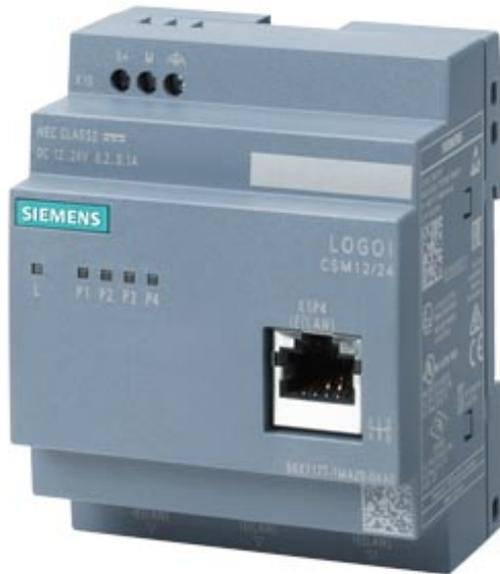
LOGO! CSM12/24 Compact Switch Modul Anschluss einer LOGO! (. . .0BA7/...0BA8) und bis zu 3 weiterer Teilnehmer an Ind. Ethernet mit 10/100 MBit/s unmanaged Switch, 4 RJ45-Ports, 1x Frontport zur Diagnose DC 12/24V Spannungsversorgung LED-Diagnose, LOGO! Aufbau
