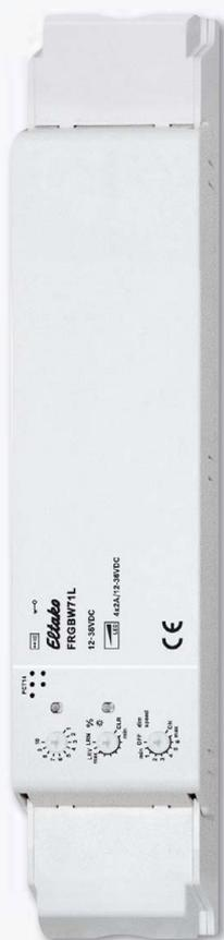
**PWM-Dimmschalter mit 4 Kanälen für LED 12-36 VDC, je bis 2 A. Mindesthelligkeit und Dimmgeschwindigkeit einstellbar. Mit Schlummer- und Lichtweckerschaltung. Zusätzlich mit Lichtszenensteuerung über PC oder mit Funktastern. Verschlüsselter Funk, bidirektionaler Funk und Repeater-Funktion zuschaltbar. Stand-by-Verlust nur 0,3-0,5 Watt.**
