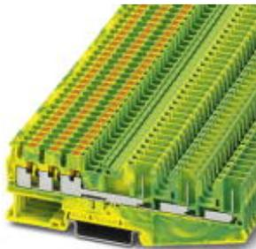
Schutzleiter-Reihenklemme, Anschlussart: Push-in- / Steckanschluss, Anzahl der Anschlüsse: 6, Querschnitt: 0,14 mm<sup>2</sup> - 4 mm<sup>2</sup>, AWG: 26 - 12, Breite: 5,2 mm, Höhe: 35,3 mm, Farbe: grün-gelb, Montageart: NS 35/7,5, NS 35/15
