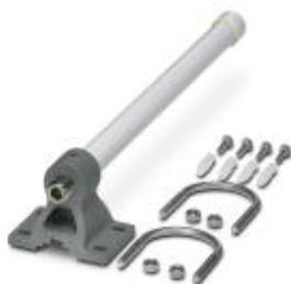
Rundstrahlantenne, 868 MHz, Gewinn: 4 dBi, Polarisation: linear, Öffnungswinkel: h/v 360°/30°, Schutzart: IP67, seewasserbeständig, Anschluss: N (female), inkl. Montagewinkel und Mastschellen, ATEX- und IECEx-Zulassung
