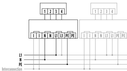
Standardbetrieb. Optional: Vernetzung mit max. 30 Meldern (max. Leitungslänge 300 m). Filter gegen netzgebundene Störungen am PROTECTOR K 230 V.
